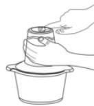
Lưu ý: khi lắp đặt hoặc tháo luôi dao, tay phải giữ phần nhựa của luôi dao, không được tiếp xúc với luôi dao để tránh bị cắt thương.
